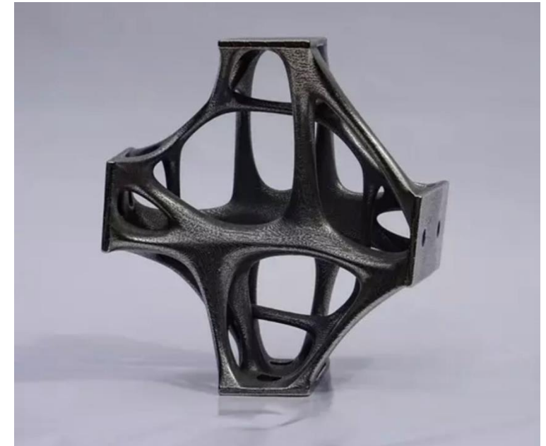
© Ulrich Knaack Kraftoptimierter Knoten einer Gitternetzschale, MSc-Projekt TU Delft
